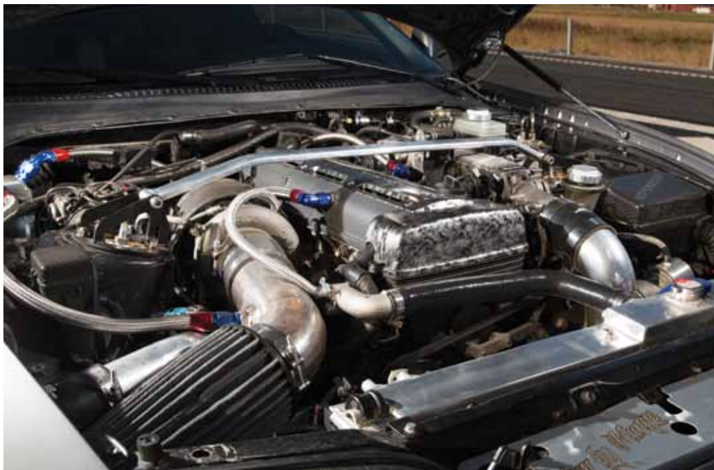
Den nästan 3 liter stora 2JZ-GTE-motorn har blivit med GT35R Turbo och en massa annat smått och gott som toppats med en dökalledoppad ventilkåpa.
