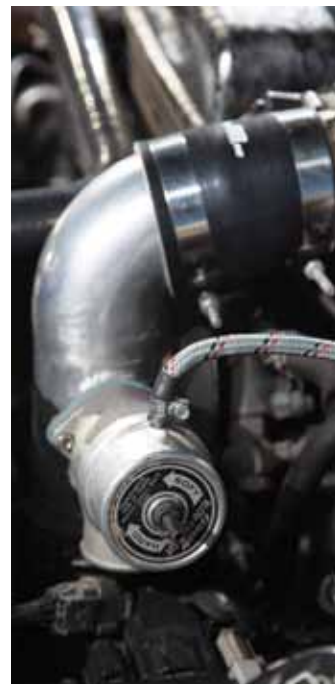
Pysandet sköts här av en stor Greddy 47mm Type-r stiff spring dumpventil.
