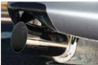
Det 3,5 tum stora avgassystemet customgjort av UppsalaAvgasteknik.se kröns med en 4 tums HKS slutdämpare.
