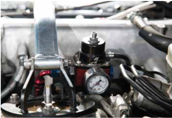
Fredrik funderade mycket över hur bränslesystemet skulle byggas i början. Det slutade med Delphi 1000cc spridare, Aeromotive BTR, PHR fuelrail och till slut dubbla original US-spec densopumpar.
